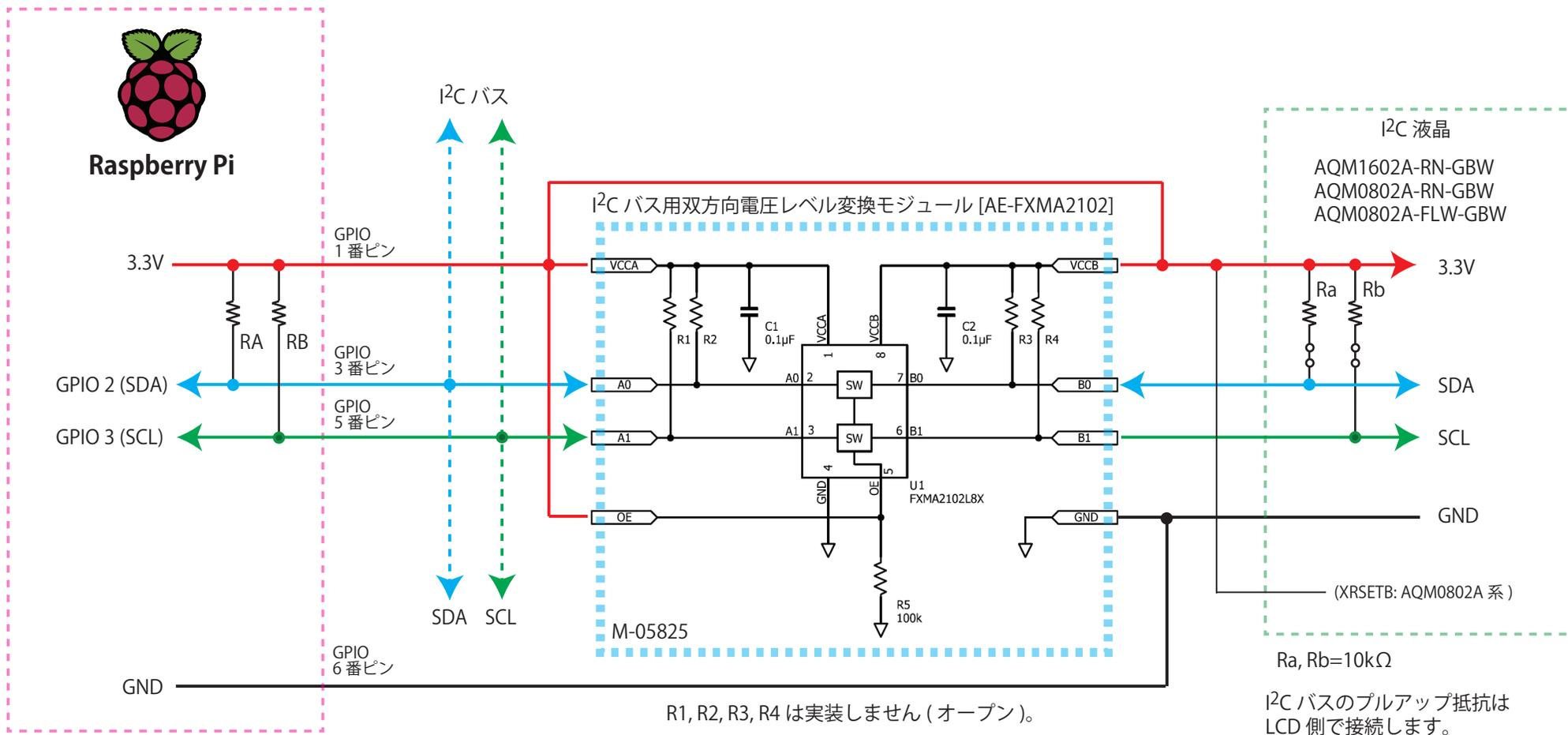
I<sup>2</sup>C バスのプルアップ抵抗 (RA, RB) は Raspberry Pi 基板に実装されています。
