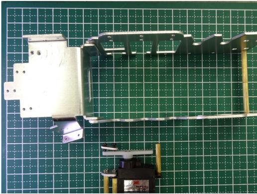
8-1.親指のサーボから固定します。ネジ(長)で固定します。
