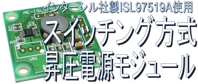
MOSFET内蔵のスイッチング電源専用ICと、動作に必要な周辺部品のみを内蔵。ハンダ付けが難しい面実装部品を小型の専用基板に実装しました。スイッチと出力電圧調整用可変抵抗器のハンダ付けのみで完成する可変型昇圧電源モジュールです。
