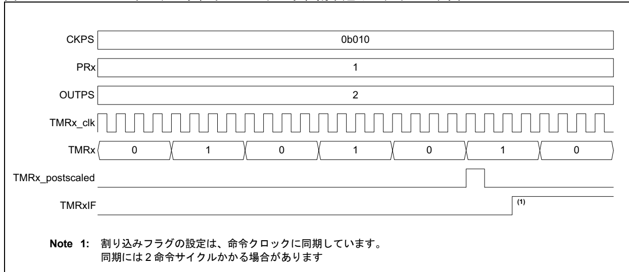
図 23-3: Timer2 プリスケアラ、ポストスケアラ、割り込みのタイミング図
