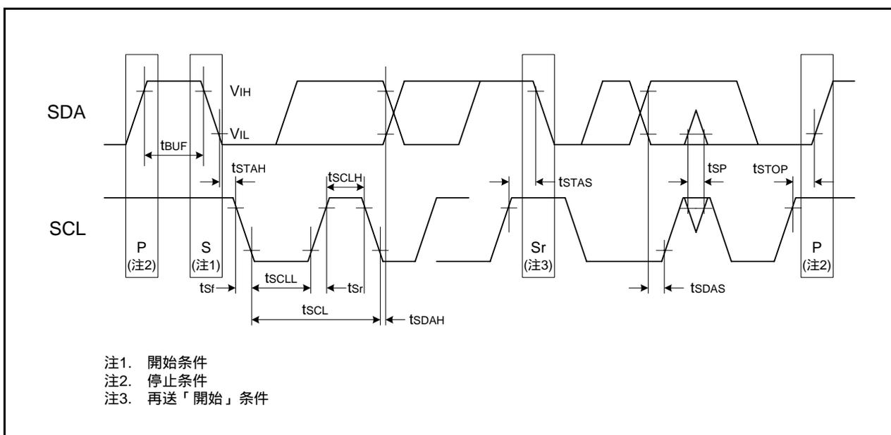
図5.7 I<sup>2</sup>Cバスインターフェースの入出力タイミング
