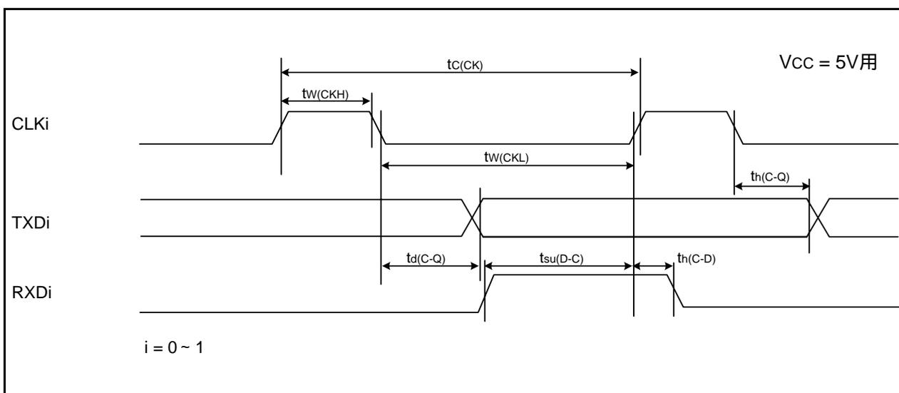
図5.29 Vcc = 5V時のシリアルインタフェースのタイミング
