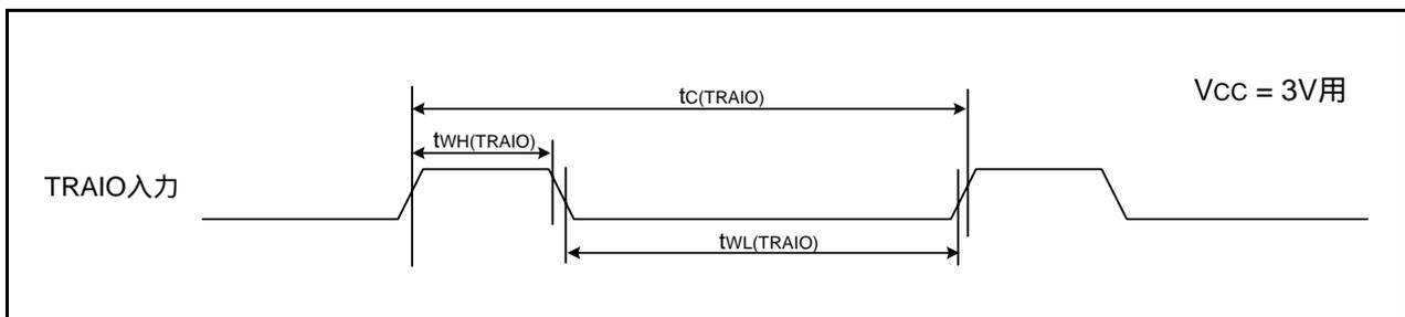
図5.32  $V_{CC} = 3V$ 時のTRAIO入力タイミング
