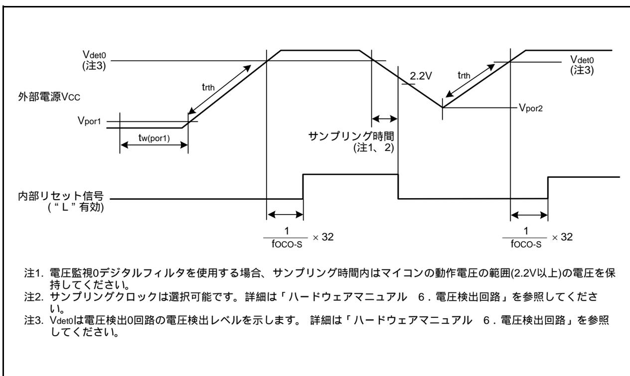
図5.3 リセット回路の電氣的特性
