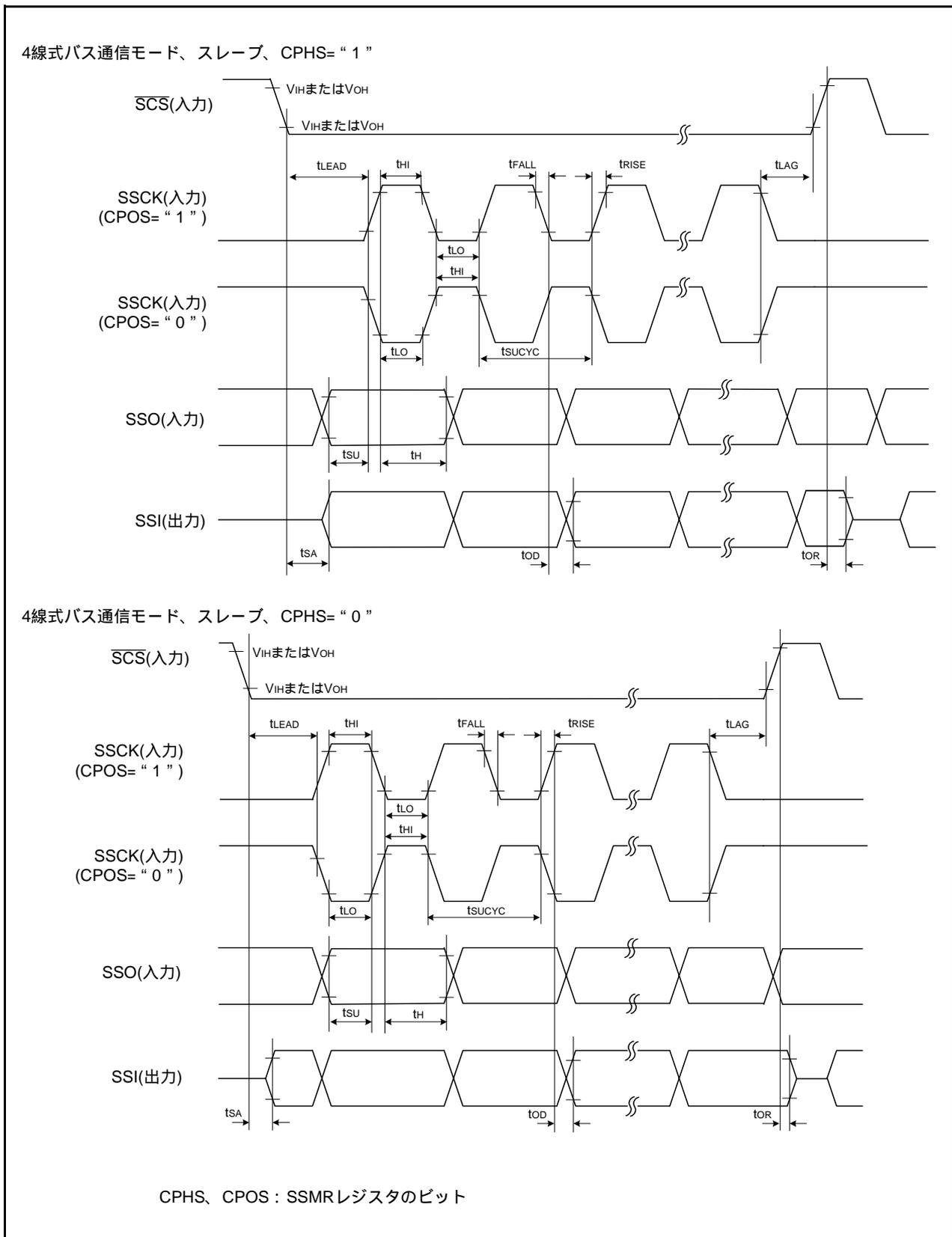
図5.24 チップセレクト付クロック同期形シリアルI/Oの入出力タイミング(スレーブ)
