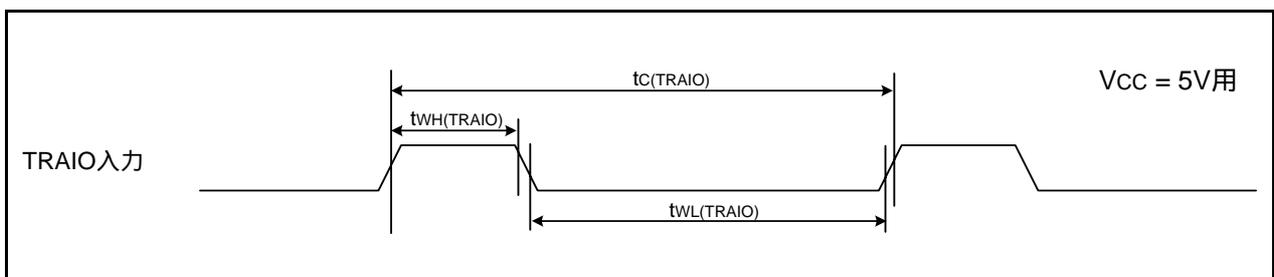
図5.9  $V_{CC} = 5V$ 時のTRAI0入力タイミング
