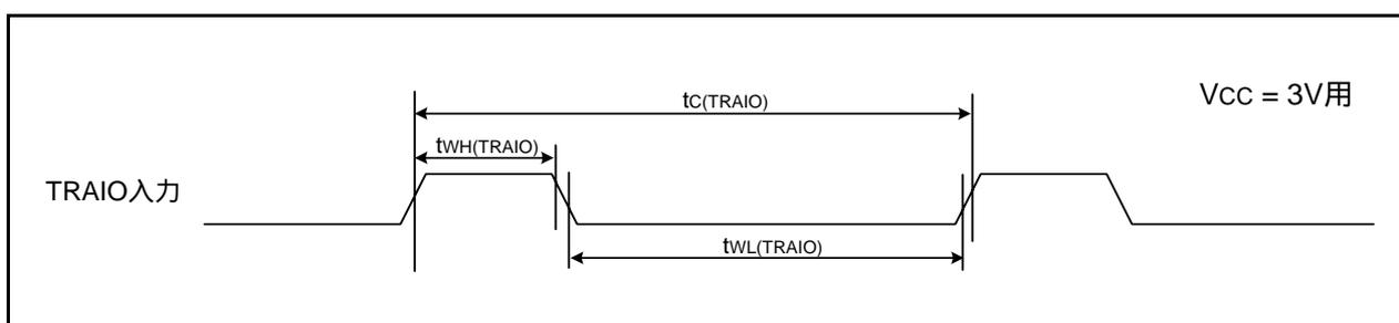
図5.13  $V_{CC} = 3V$ 時のTRAIO入力タイミング
