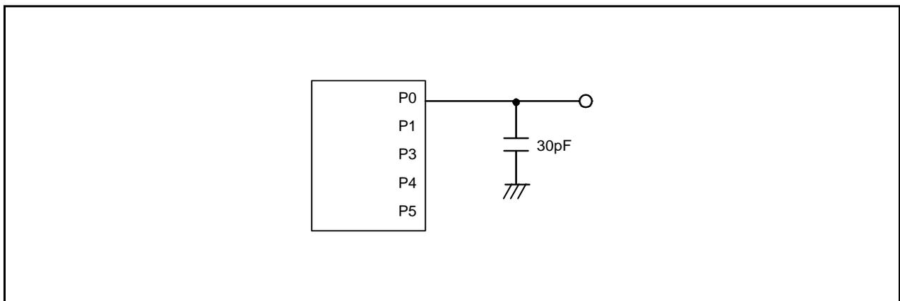
図5.1 ポートP0、P1、P3～P5のタイミング測定回路
