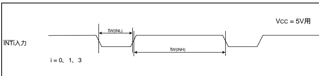
図5.30 Vcc = 5V時の外部割り込み $\overline{\text{INT}}_i$ 入力タイミング
