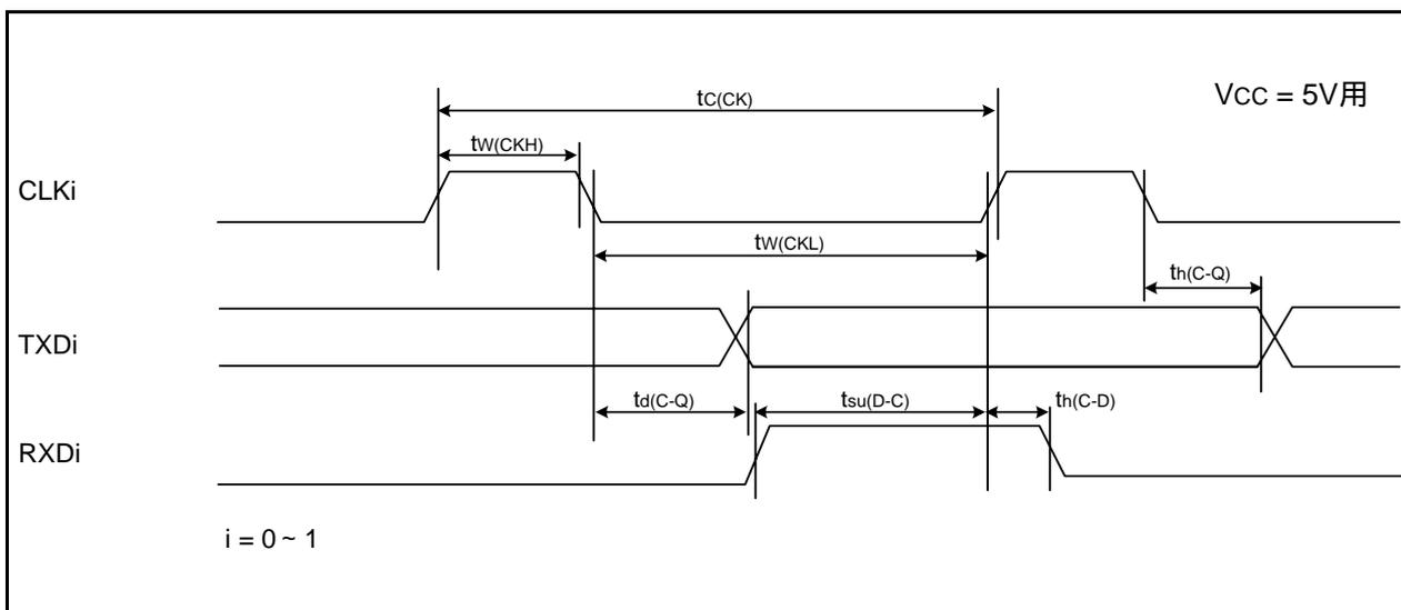
図5.10 Vcc = 5V時のシリアルインタフェースのタイミング
