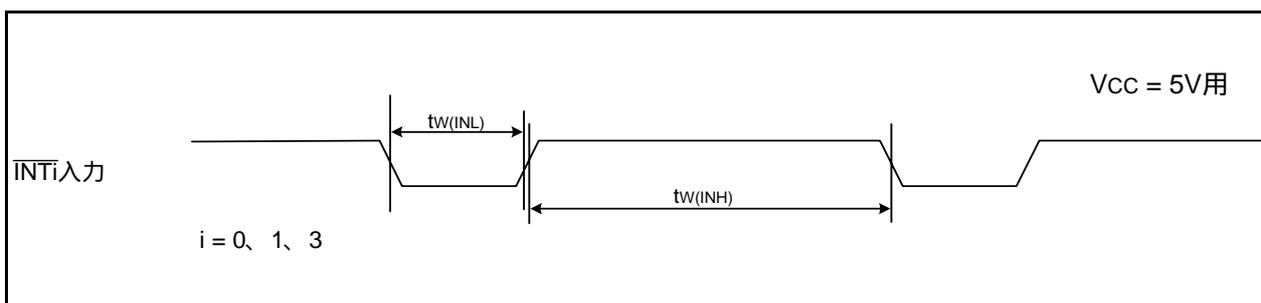
図5.11 Vcc = 5V時の外部割り込み $\overline{\text{INT}}_i$ 入力タイミング
