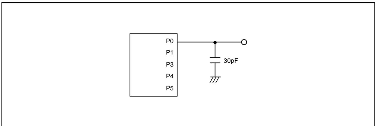
図5.20 ポートP0、P1、P3～P5のタイミング測定回路
