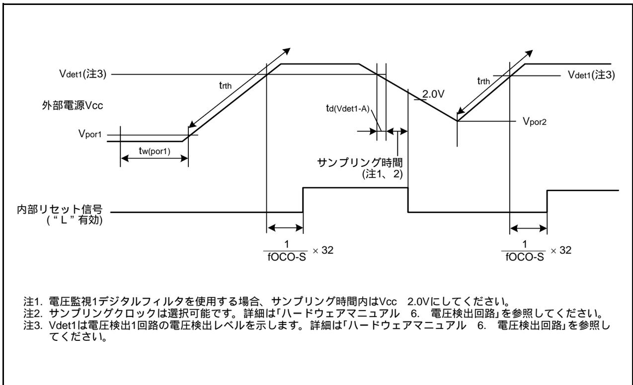
図5.22 パワーオンリセット回路の電気的特性
