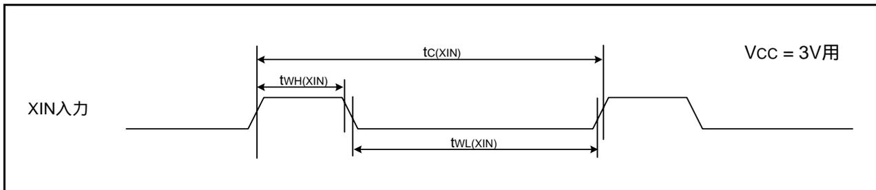
図5.31  $V_{CC} = 3V$ 時のXIN入力タイミング
