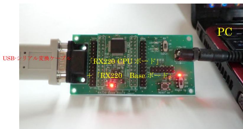
PC+USB-シリアル変換ケーブル + 「RX220 Base ボード」 + 「RX220 CPU ボード」 接続外観
