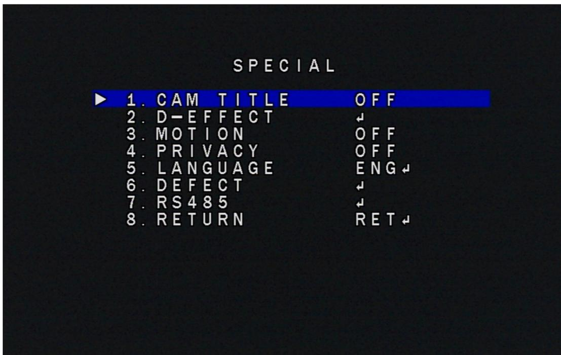
7-1 : D-EFFECT : “D-EFFECT” を選択して、設定ボタンを押して、FREEZE、MIRROR、NEG.IMAGE が調整できます
