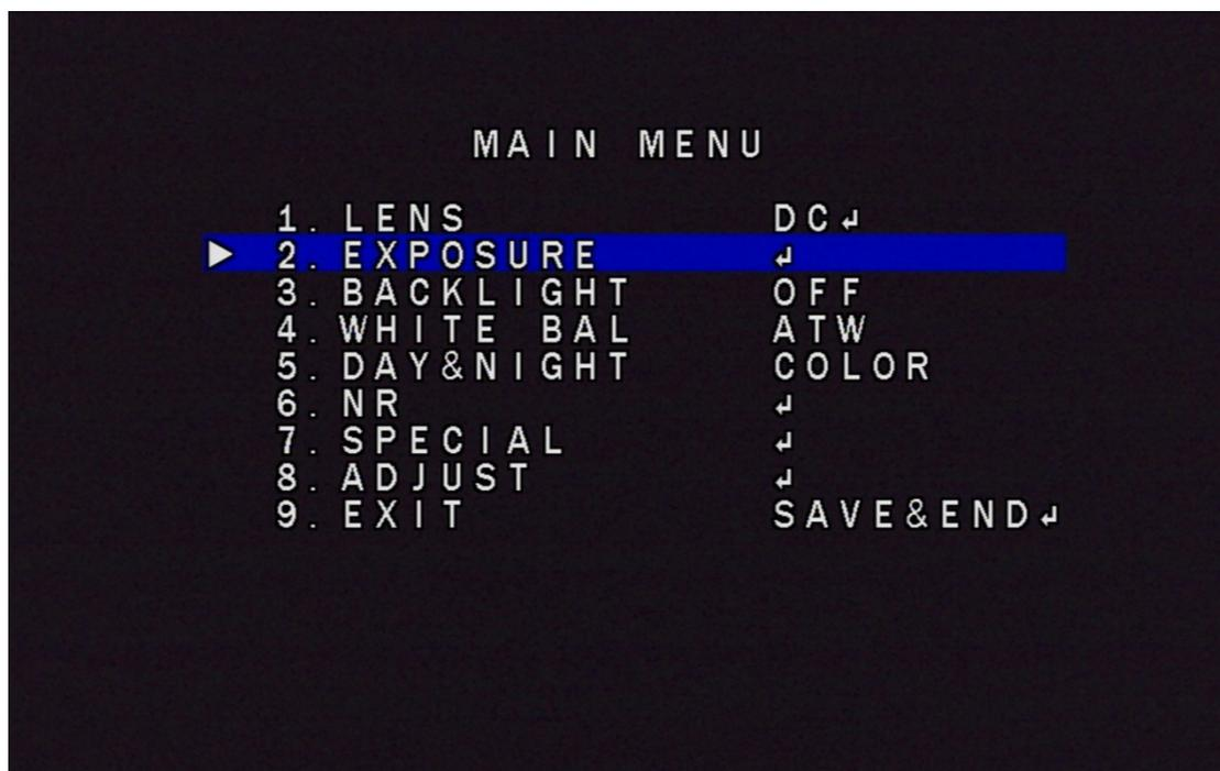
2-1 : EXPOURE に設定ボタンを押して、SHUTTER、AGC、SENS-UP、明るさ、D-WDR、DEFOG が選択できます
