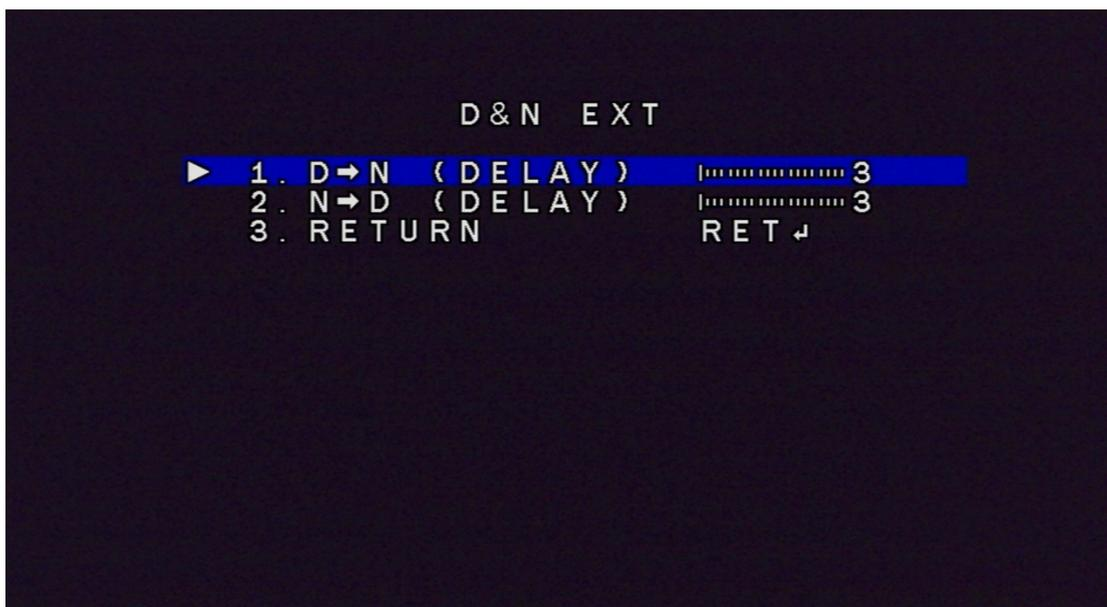
5-2 : オート : “オート” を選択して、設定ボタンを押して、D→N(AGC)、D→N(DELAY)、N→D(AGC)、N→D(DELAY)数値が調整できます
