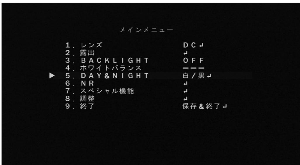
5-1 : EXT : “EXT” を選択して、設定ボタンを押して、D→N(DELAY)、N→D(DELAY)数値が調整できます
