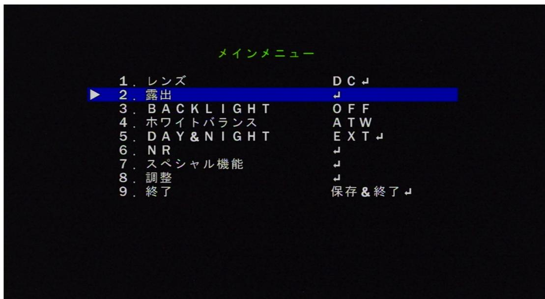
2-1：露出に設定ボタンを押して、シャッター、AGC、SENS-UP、明るさ、D-WDR、DEFOG が選択できます
