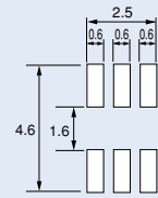
推奨はんだ付けパターン Recommended soldering patterns
