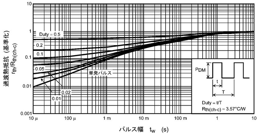
図 8.13  $r_{th}/R_{th(ch-c)} - t_w$
