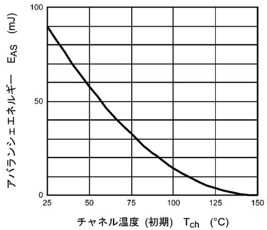
図 8.15  $E_{AS} - T_{ch}$
