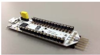
TWE-Lite DIP 上部からの書き込み用に 5P ピンヘッダを取り付けた例です。
