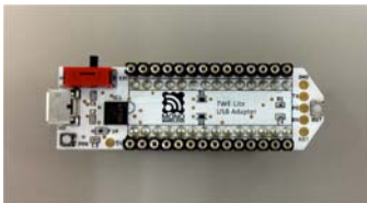
USB 電源の切り替え用の端子にスイッチを取り付けた例です。
