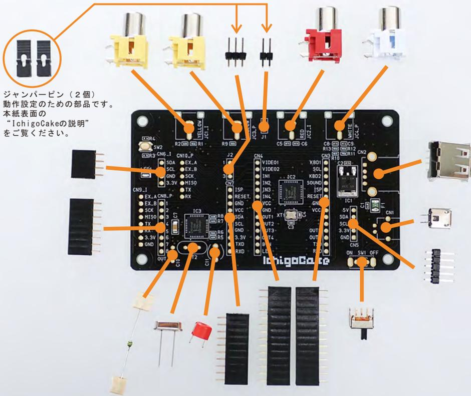
完成写真を参考に、基板上の印形状に合わせて部品を挿し込み、はんだ付けしてください。はんだ付けは、作業性を考慮し、背の低い部品から取り付けていきます。あくまで作業性の問題なので、厳密な順番があるわけではありません。
