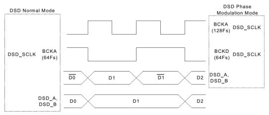
Figure 15. DSD Phase Modulation Mode Diagram
