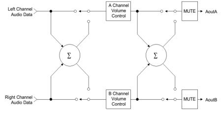
Figure 20. ATAPI Block Diagram
