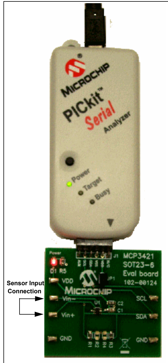
図 7-2: MCP3421 評価用ボードと PICkit™ シリアルアナライザの接続
