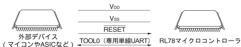
図20-3 フラッシュ・メモリにプログラムを書き込むための環境
