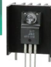
放熱器と三端子レギュレータを一体にして、ねじを弱めに締めます。基板の穴に差し込み、垂直になっているか確認しながら少しずつねじを締めます。
