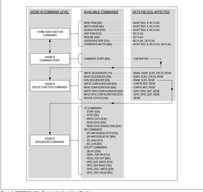
Figure 1. DS28E18 1-Wire Commands Hierarchical Structure
