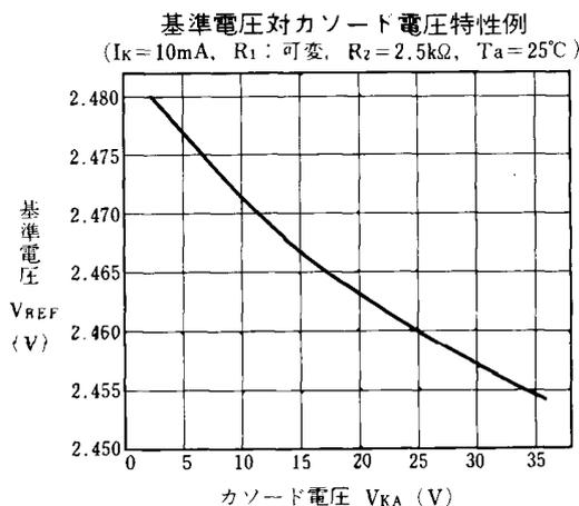
図 7 基準電圧対カソード電圧特性例
