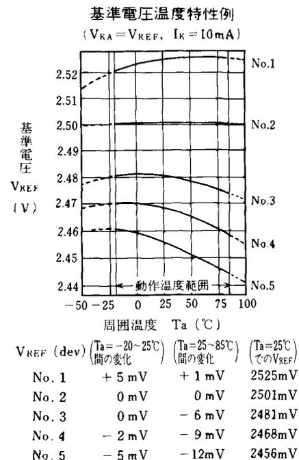
図 6 基準電圧温度特性例
