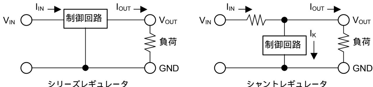
図1 リニアレギュレータの制御方式
