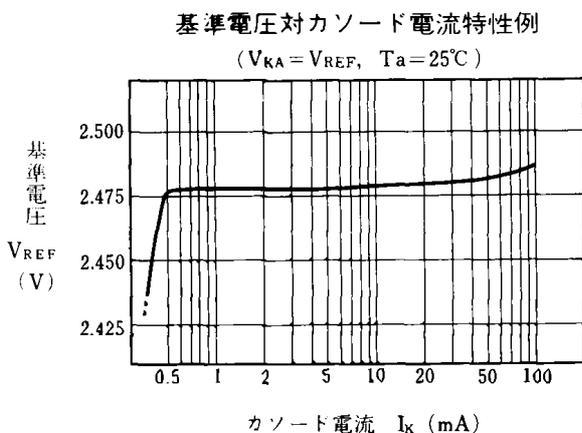
図 5 基準電圧対カソード電流特性例
