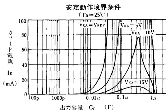
(注) 安定曲線の内側で動作させると、発振する場合があります。使用に際しては、デバイスのバラツキを考慮して十分なマージンを取り御使用下さい。
