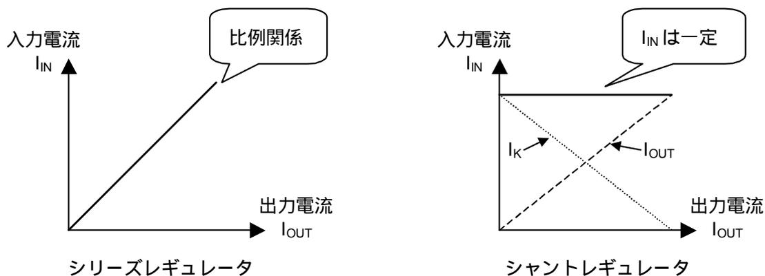
図2 出力電流と入力電流の関係
