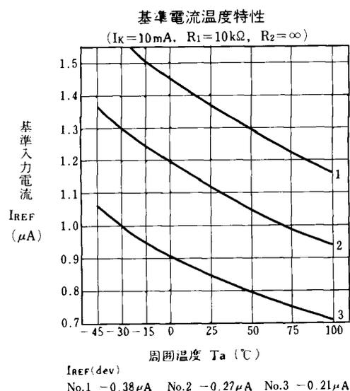
図8 基準入力電流温度特性例
