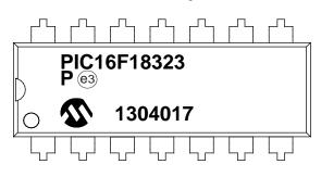
14-Lead SOIC (3.90 mm)
