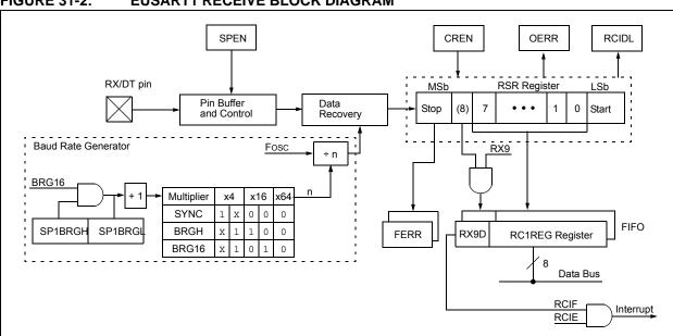
FIGURE 31-2: EUSART1 RECEIVE BLOCK DIAGRAM
