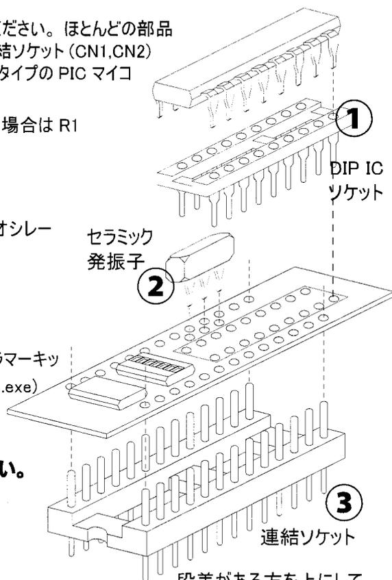
段差がある方を上にして最後に基板を取り付けます。
